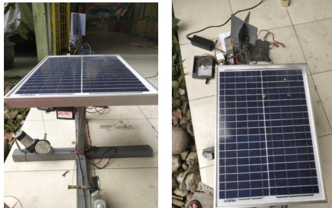
Gambar 2 Rangkaian Panel Surya Tracker 4 Titik
