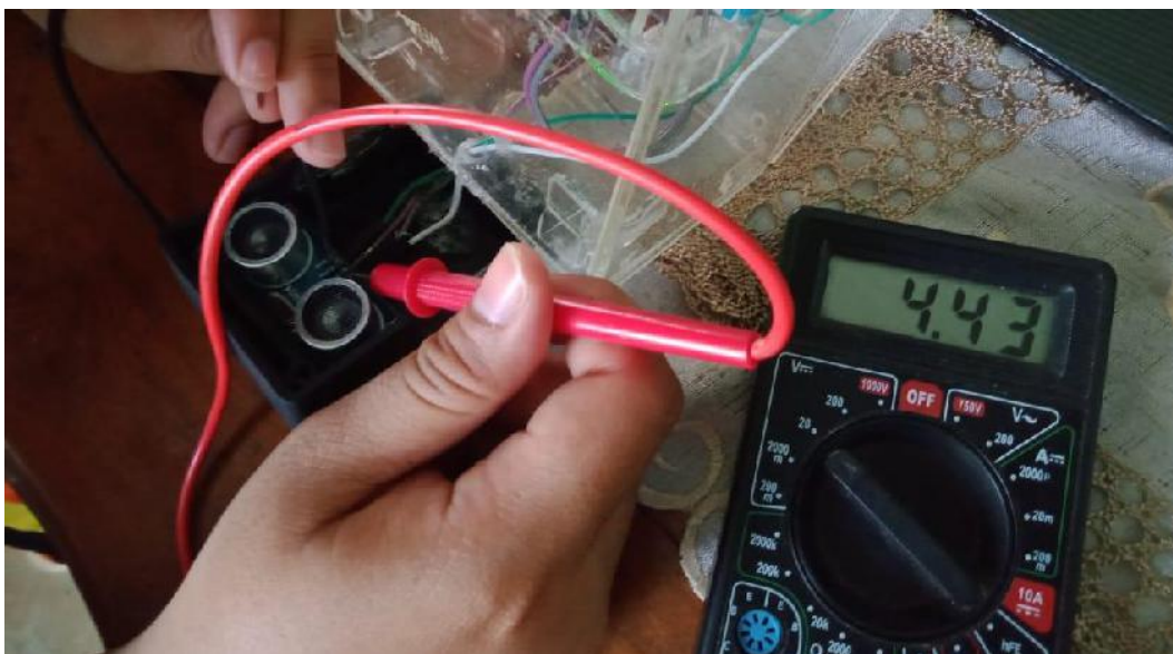
Gambar 4.13. Pengukuran Tegangan Sensor
