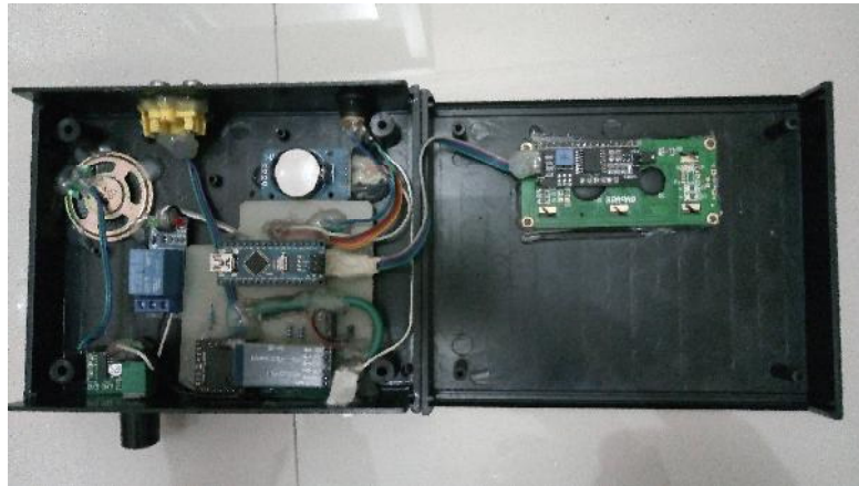
Gambar 4.16 Tampilan dalam perangkat keras bel sekolah
