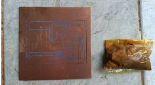
Gambar 4.3 Pelarutan PCB dengan Ferrichloride( \text{FeCl}_3 )
