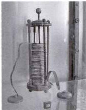
**Gambar 2.1 Baterai Buatan Alessandro Volta**
