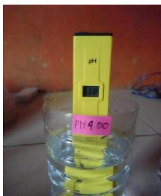
Gambar 3.7 Angka Yang Keluar Sebelum Dikalibrasi.
