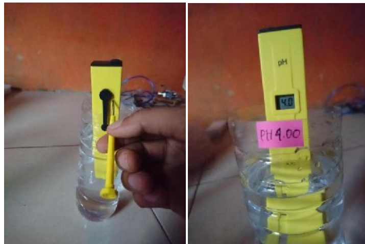
Gambar 3.8 Memutar Adjuster Trimmer Pada pH Meter dan Hasilnya.
