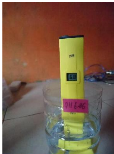
Gambar 3.9 Angka yang tertera di larutan pH 6.86.
