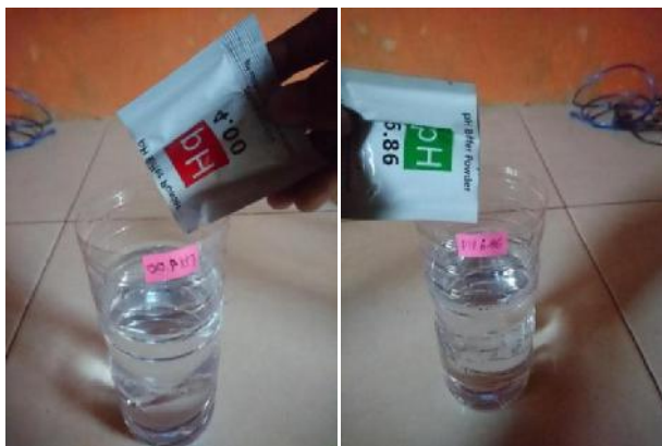
Gambar3.6 Memasukkan pH Buffer Powder Ke Wadah.
