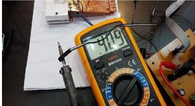
**Gambar 4.3 Foto Pengukuran Sensor pada Suhu  $40^\circ\text{C}$ .**
