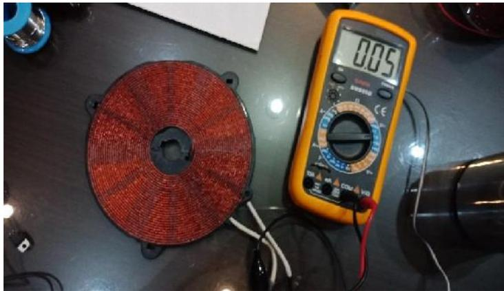
**Gambar 4.6 Pengujian Pengukuran Kumparan Induksi.**
