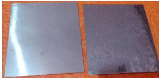
**Gambar 4.10 Plat Aluminium dan Besi dengan Ketebalan 0.9 mm.**
