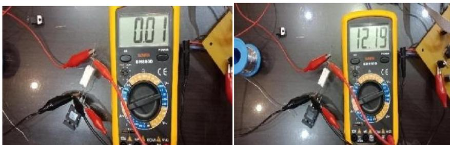
**Gambar 4.4a-b. Pengukuran pada Driver Transistor IGBT.**
