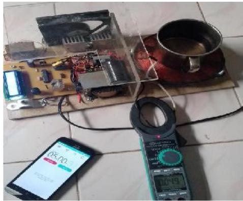
**Gambar 4.13 Pengukuran Suhu dan Waktu Pemanasan Air.**
