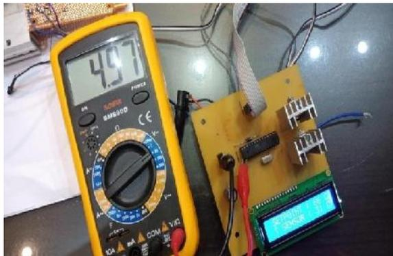
**Gambar 4.1** Pengukuran pada Pin Mikrokontroler Atmega 8
