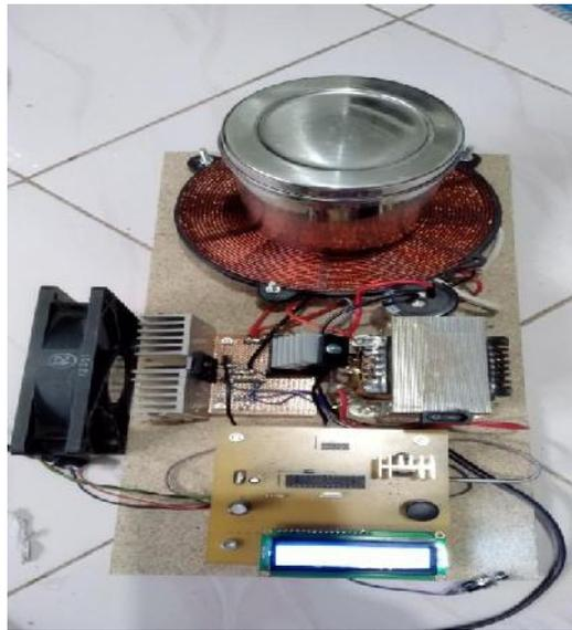
**Gambar 3.16** Keseluruhan Alat Pemanas Induksi
