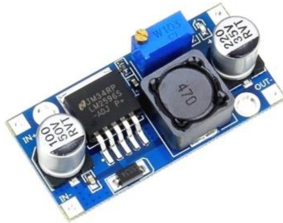
Gambar 2.14 Bentuk Fisik LM2596
