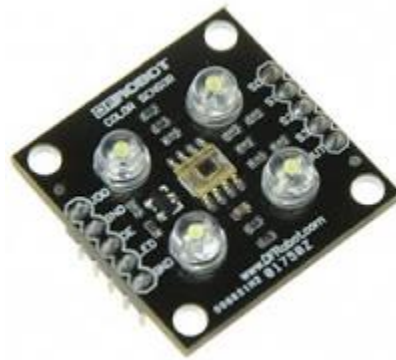
Gambar 2.5 Bentuk Fisik Sensor Warna TCS3200
