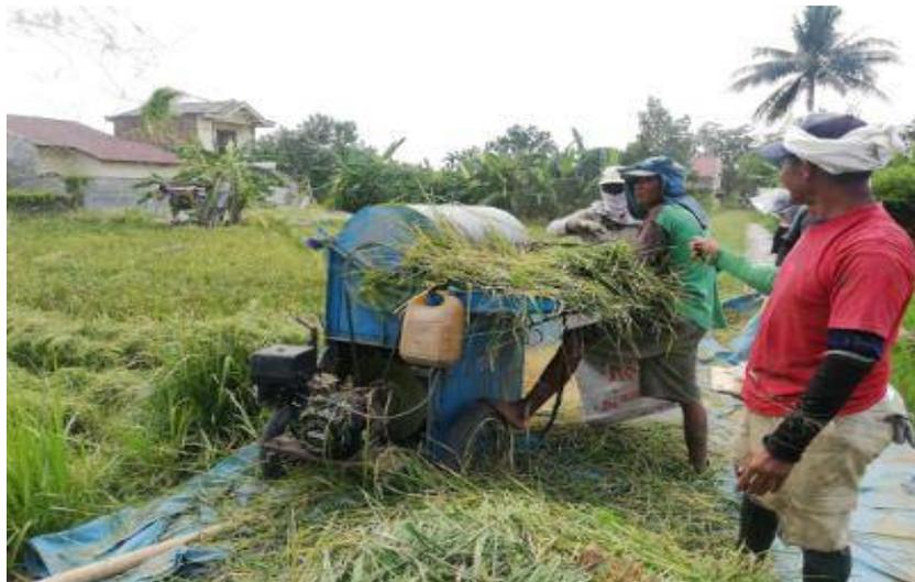
**Gambar 2.2 Proses Merontokan Padi Menggunakan Mesin Perontok Berbahan Bakar Minyak.**
