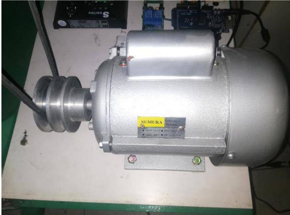
**Gambar 2.17 bentuk Fisik Motor 1 phasa**
