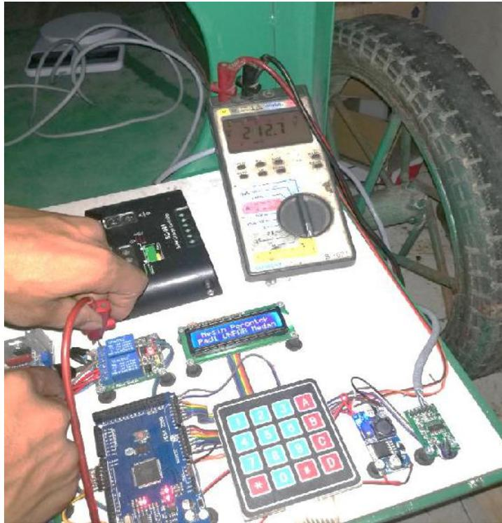
**Gambar 4.6 Pengukuran Nilai Tegangan Motor Listrik AC Pada Saat Kondisi ON**
