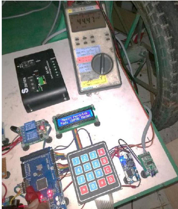
**Gambar 4.5 Pengukuran nilai tegangan relay pada saat posisi ON**
