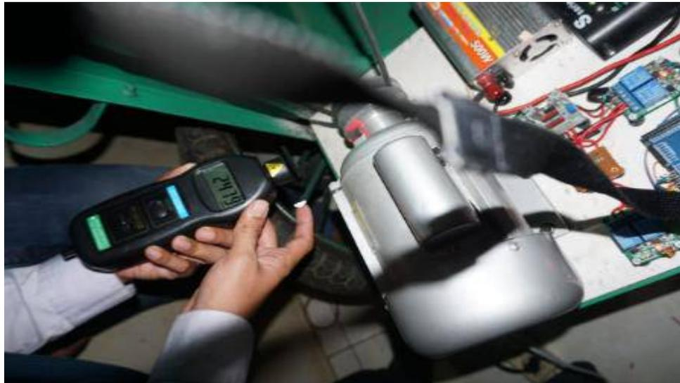
**Gambar 4.8 Pengukuran nilai RPM Motor**
