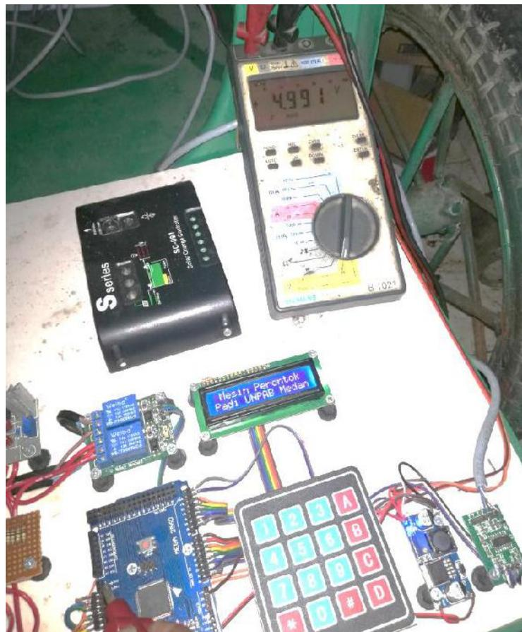
**Gambar 4.4. Pengukuran nilai tegangan relay pada Saat posisi Off**
