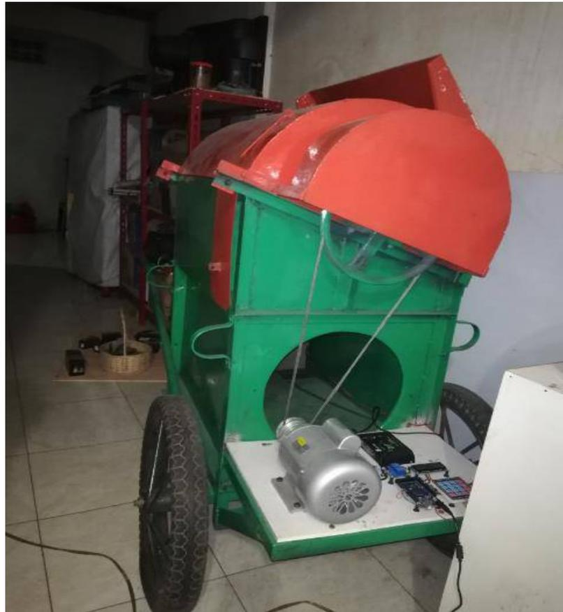
**Gambar 4.1 Bentuk Fisik Mesin Perontok Padi Otomatis Berbasis Mikrokontroller**
