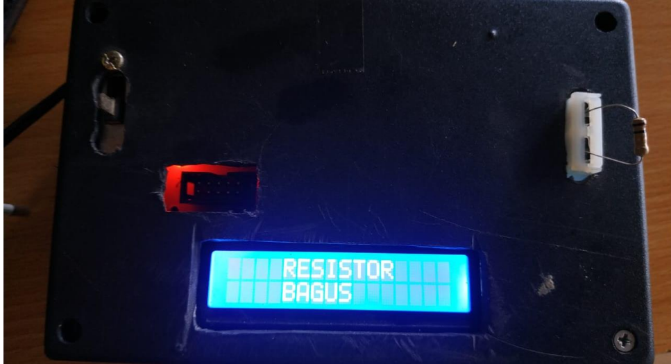
Gambar 4.3 Pengujian Resistor Bagus Penulis, 2019
