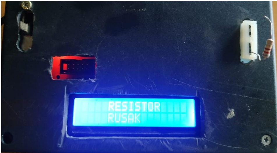
Gambar 4.4 Pengujian Resistor Rusak Penulis, 2019
