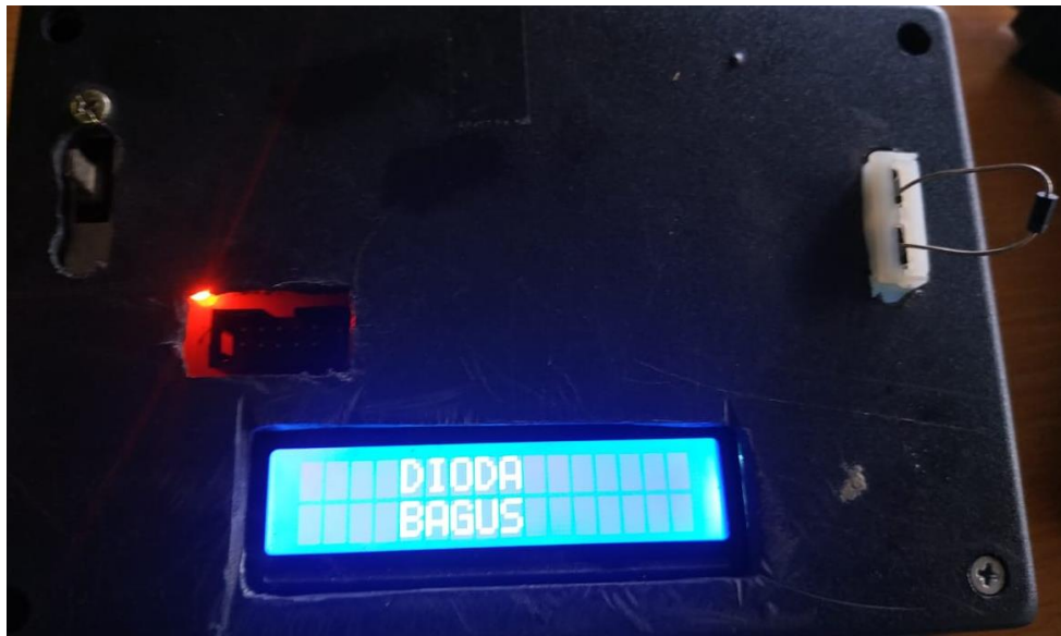
Gambar 4.7 Pengujian Dioda Bagus Penulis, 2019
