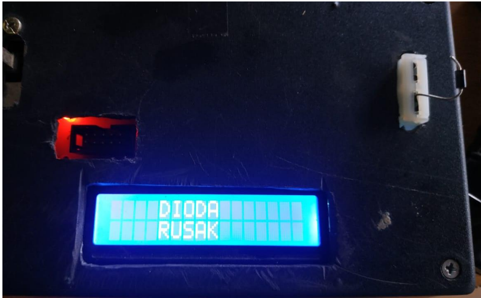
Gambar 4.8 Pengujian Dioda Rusak Penulis, 2019
