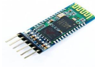
Gambar 2.4 Module Bluetooth Hc-05 Sumber : Akhmad Zainuri, (2015)
