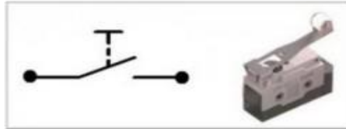
Gambar 2.12 Simbol dan Bentuk Limit Switch
