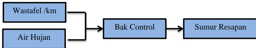
**Gambar 4.16** Skema Pembuangan *Grey Water*
