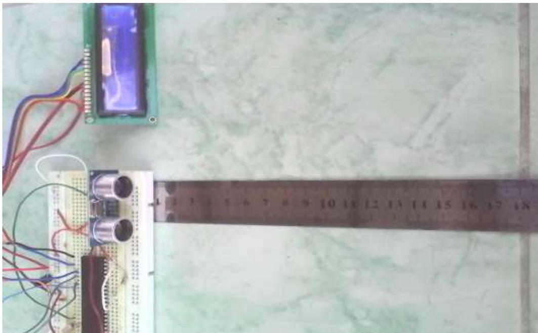
**Gambar 4.2 Pengujian Jarak Sensor**
