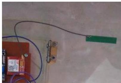
**Gambar 2.9 Tampilan fisik Modul SIM 800L GSM**
