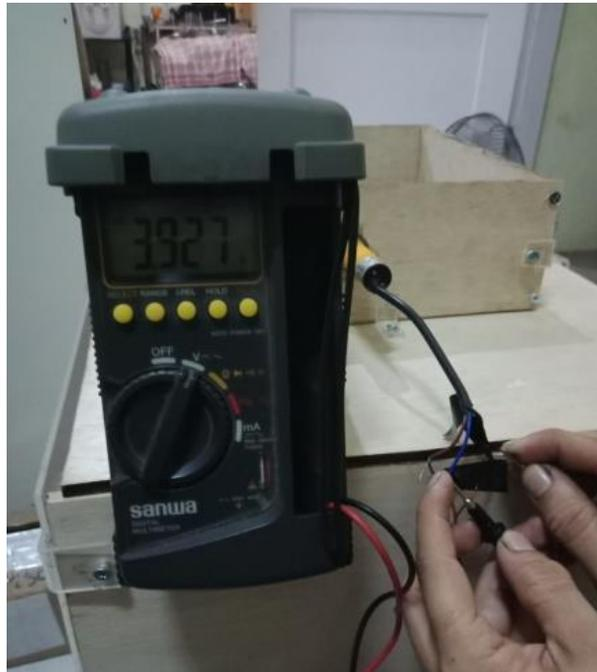
**Gambar 4.14 Hasil pengukuran sensor infrared jika tidak ada objek**
