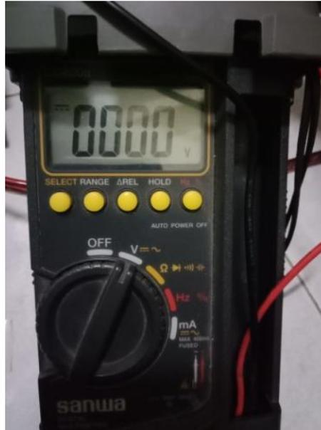
**Gambar 4.11 Hasil pengukuran sensor proximity mendeteksi logam**
