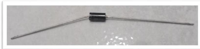
**Gambar 2.17 Bentuk Dioda 1N4007**
