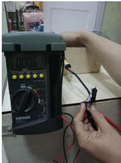
**Gambar 4.13 Hasil pengukuran sensor infrared jika ada obyek**
