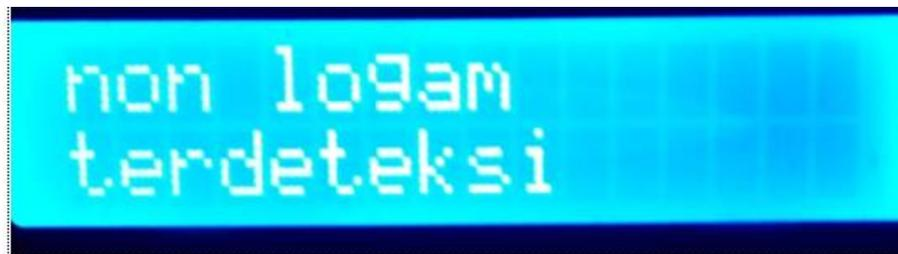
**Gambar 4.7 Tampilan LCD saat nonlogam terdeteksi**
