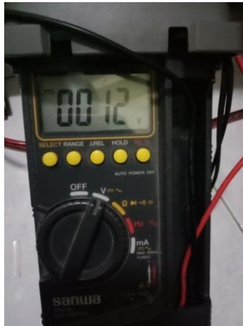
**Gambar 4.12 Hasil pengukuran sensor proximity tidak mendeteksi logam**
