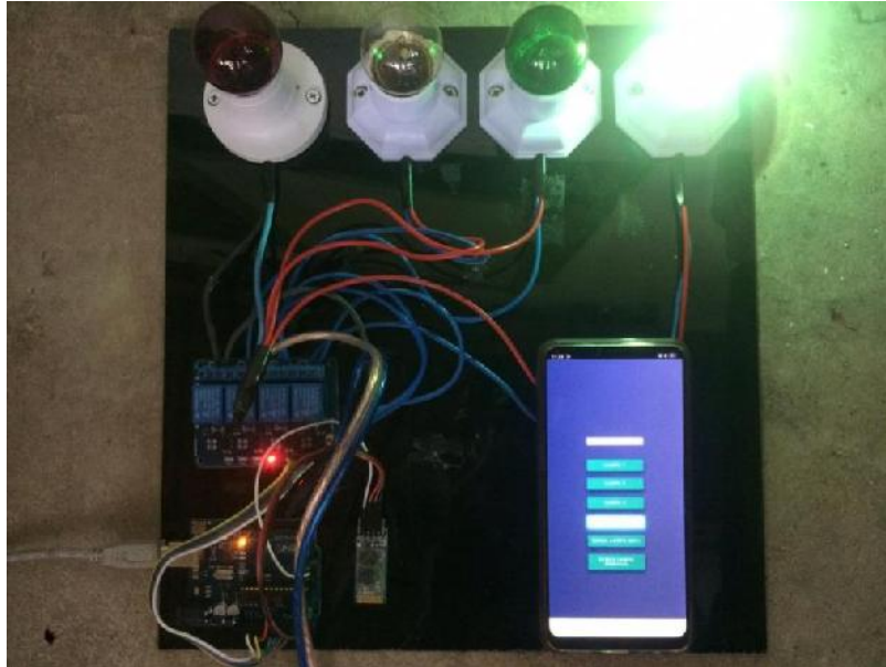
Gambar 4.12 Rangkaian Alat kendali lampu Sumber: Penulis, 2019
