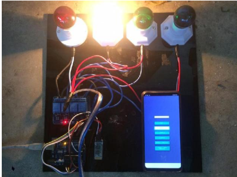
Gambar 4.10 Rangkaian Alat kendali lampu Sumber: Penulis, 2019
