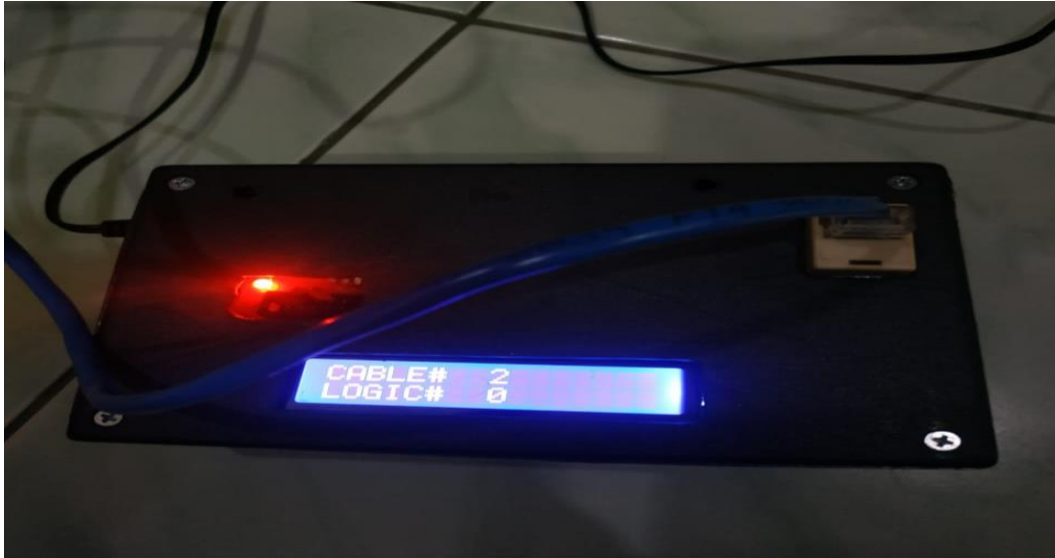
Gambar 4.9 Tampilan LCD pada saat kabel diputus Penulis, 2019
