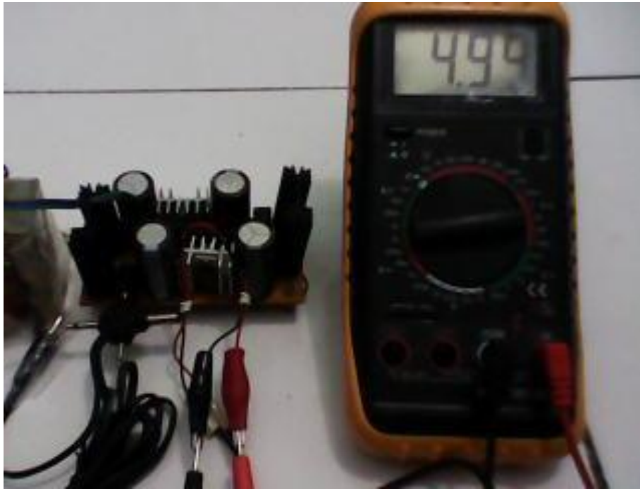
Gambar 4.3 Mengukur Tegangan Catu Daya Penulis, 2019
