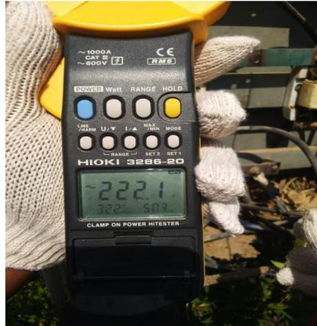
Gambar 3.7 pengukuran tegangan dengan tang ampere (Sumber : Dokumentasi Pribadi )
