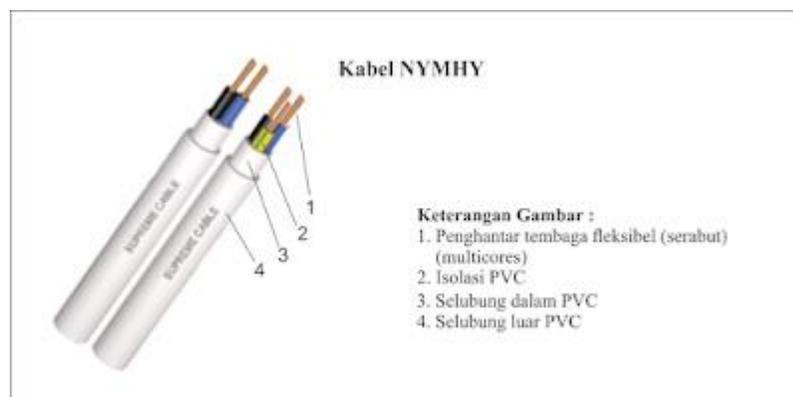
Gambar 2. 10 Kabel NYMHY (Sumber : <https://www.blogteknisi.com/2016/05/mengenal-9-jenis-kabel-listrik.html>)
