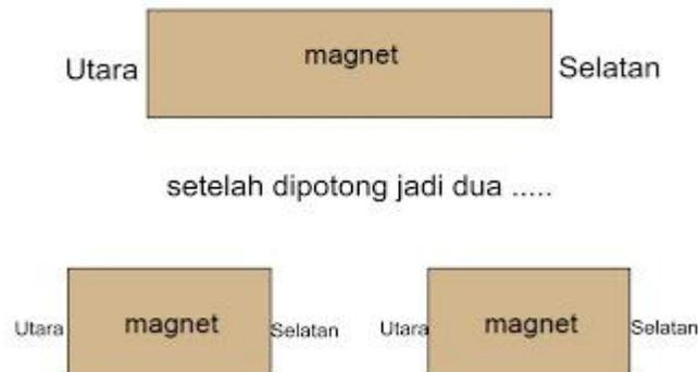
**Gambar 2.28: Magnet yang dipotong-potong**
