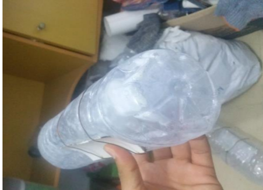
Gambar 3.18. Menggunakan karbit di dalam botol untuk meningkatkan tekanan udara di dalam botol
