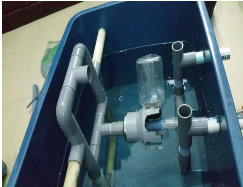
Gambar 3.30. Poros kincir botol telah terpasang pada kedudukan di dalam kotak
