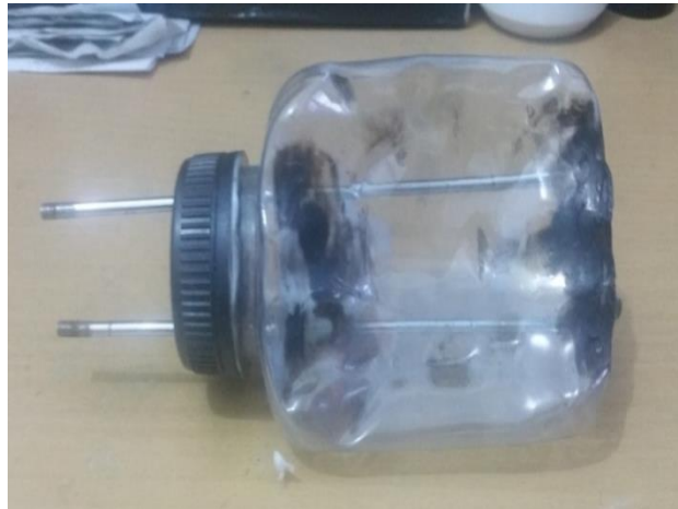
Gambar 3.10. Botol segitiga dipasang jari-jari untuk disambung ke pipa
