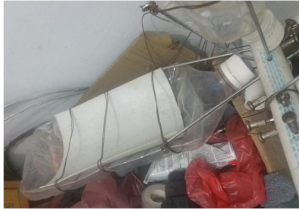
Gambar 3.12. Botol dibentuk segitiga dan dipasang pipa lengkung
