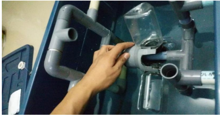
Gambar 4.6. Proses pengujian kincir botol pada kotak air
