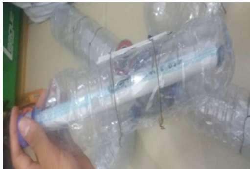
Gambar 3.17. Penambahan bola mimis dan pipa sebagai jalur bola mimis di dalam botol
