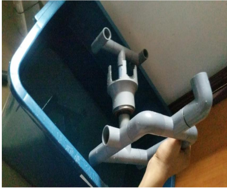
Gambar 3.29. Pemasanganudukan poros kincir pada kotak air
