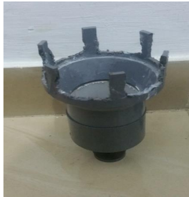
Gambar 3.14. Pipa Adapter didesain sebagaiudukan botol dan bearing
