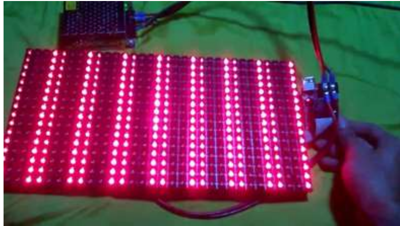
Gambar 4.3 Hasil Pengujian Modul P10
