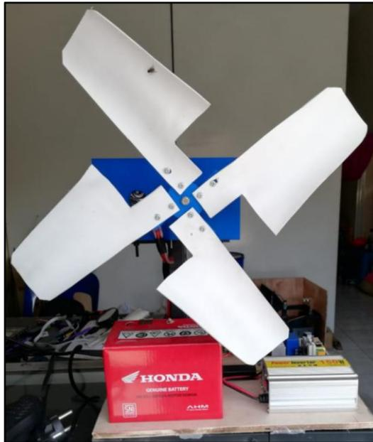
**Gambar 4.1 Bentuk Fisik *Prototype* Kincir Angin Pada Sumbu Horizontal**
