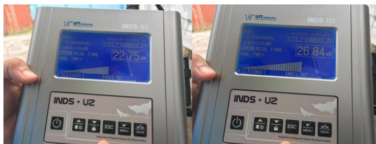
Gambar4.5 Monitoring display Ultrasonik saat menemukan titik gangguan.
