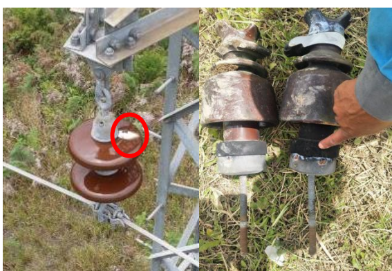
Gambar4.6 Komponen rusak dan ketahuan dari hasil metode Ultrasonika
