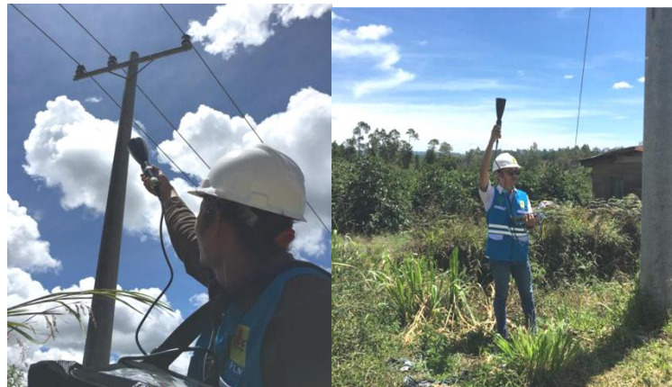
Gambar 4.4 Proses Inspeksi menggunakan Ultrasonik (Dokumentasi Penulis, 2018)
