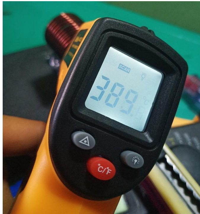
Gambar 4.9 Suhu pisau cutter setelah dipanaskan Sumber : Penulis, 2019
