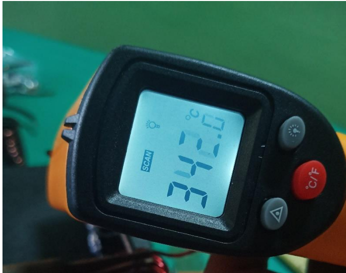
Gambar 4.13 Suhu paku setelah dipanaskan
