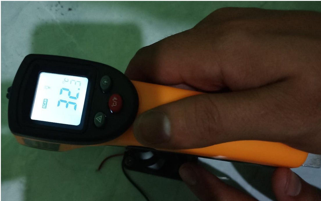
Gambar 4.16 Suhu aluminium setelah dipanaskan
