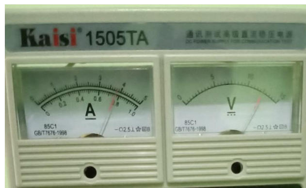
Gambar 4.10 Arus beban pisau cutter Sumber ; Penulis, 2019
