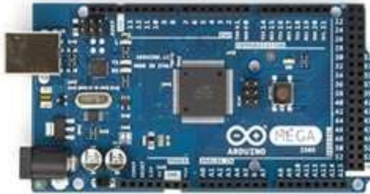
Gambar 2.1 Board Arduino Mega 2560 Tampak Depan (Yuhardiansyah,2016)
