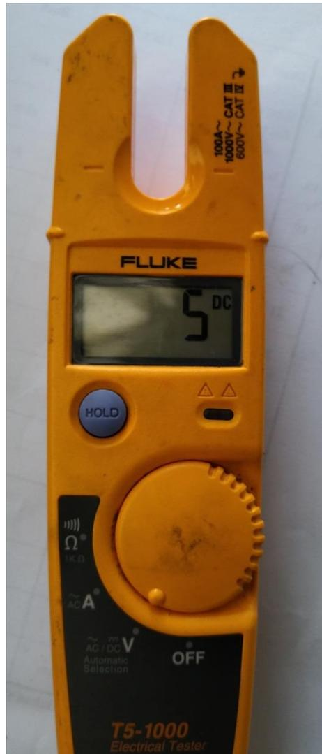
**Gambar 4.6 Hasil Pengukuran Tegangan Output Buzzer pada saat berbunyi**
