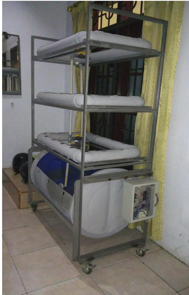
**Gambar 3.4 Hasil akhir Konstruksi Akuaponik**
