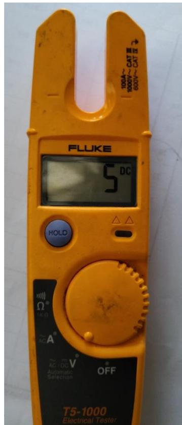
**Gambar 4.3 Hasil pengukuran ketika probe negatif diletakkan pada Pin Vcc**
