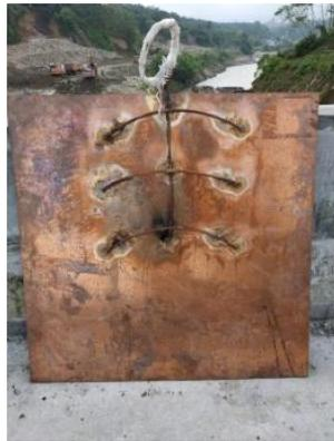
**Gambar 2. 8 Elektroda Pelat**
