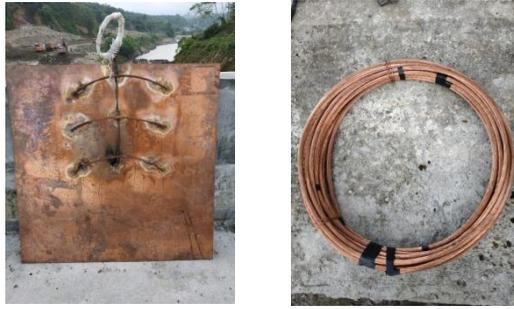
**Gambar 3. 4 Elektroda dan Kabel yang digunakan**
