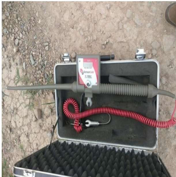
Gambar 2.18 Alat ukur Volt Stick untuk mengukur Tegangan 20 Kv
