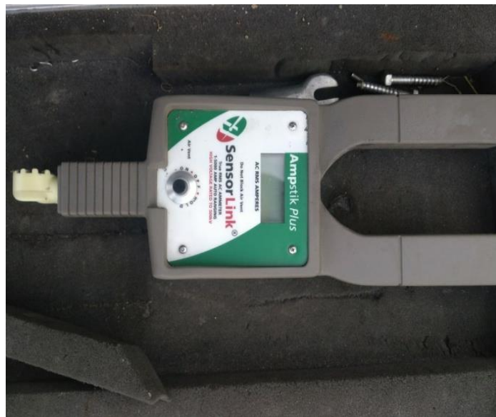
Gambar 2.20. Alat Ukur Amp Stick untuk mengukur Arus
