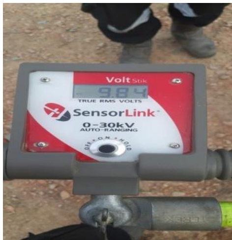
Gambar 4.2. Tegangan Phasa S
