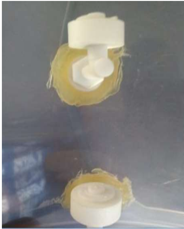
Gambar 3.2 Penyambungan Wadah dan Sensor Air
