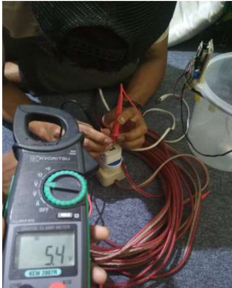
Gambar 4.8 Pengukuran Tegangan Keluaran Power Supply Sumber : (Penulis, 2019)
