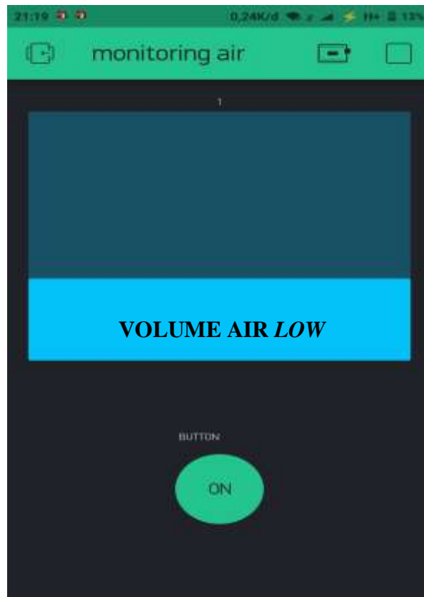
Gambar 4.2 Tampilan Aplikasi Blynk pada saat Pompa Air Menyentuh Sensor Ketinggian Air Sumber : (Penulis, 2019)
