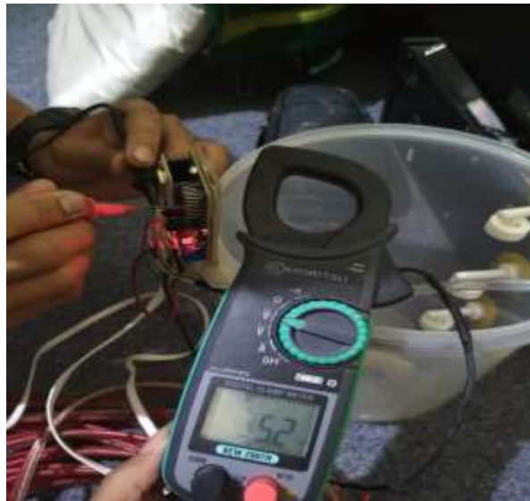
Gambar 4.9 Hasil Pengukuran Tegangan Input NodeMCU ESP8266
