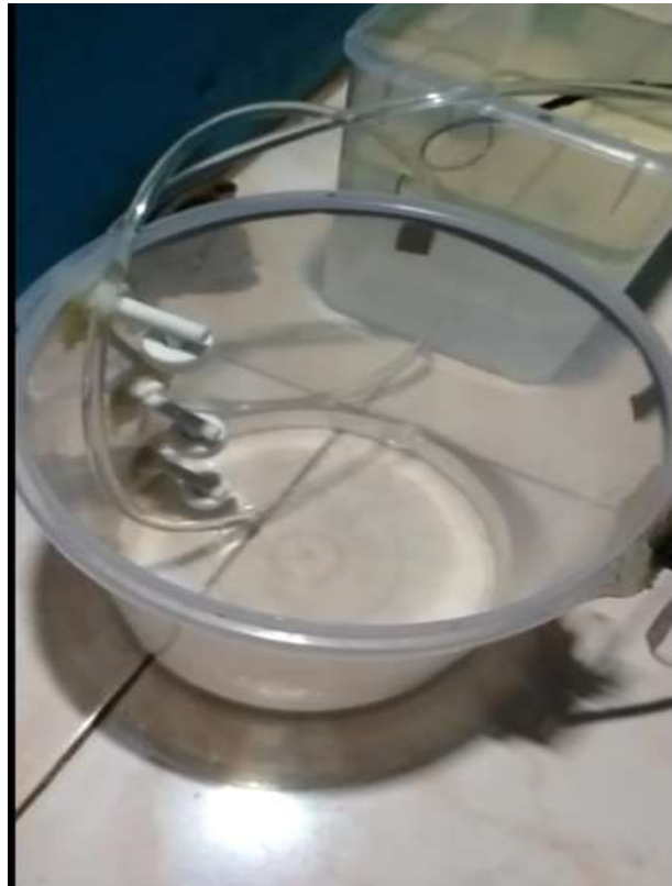
Gambar 4.3 Wadah menyentuh Sensor Ketinggian Air yang Pertama
