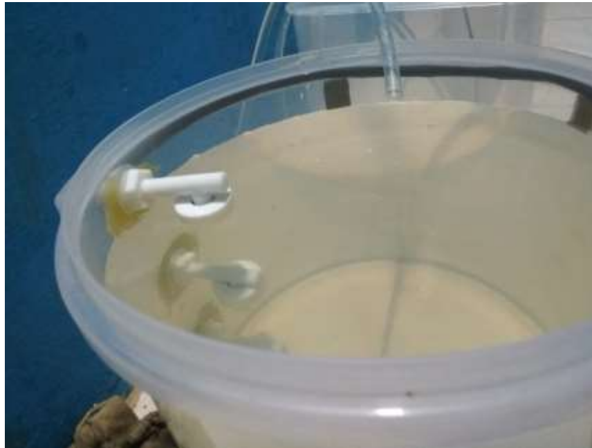
Gambar 4.7 Wadah menyentuh Sensor Ketinggian Air yang paling atas
