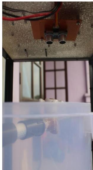
**Gambar 4.3 Letak Sensor Ultrasonik**
