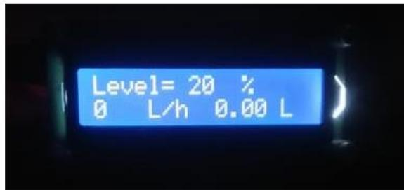
**Gambar 4.9 Tampilan LCD Ketika Air Di Level Terendah**
