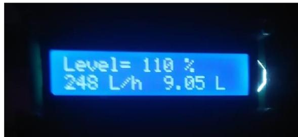
**Gambar 4.10 Tampilan LCD Ketika Air Terisi Penuh**
