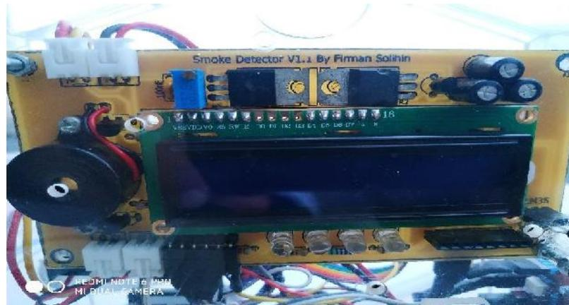
**Gambar 3.12 :** Komponen yang telah dipasang ke PCB
