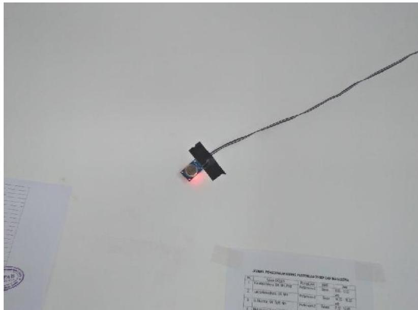
**Gambar 4.15:** Sensor MQ2 yang terpasang di ruang pengujian
