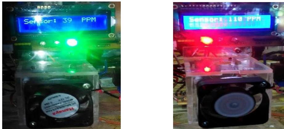
**Gambar 4.11:** Hasil Pengujian Sensor MQ-2
