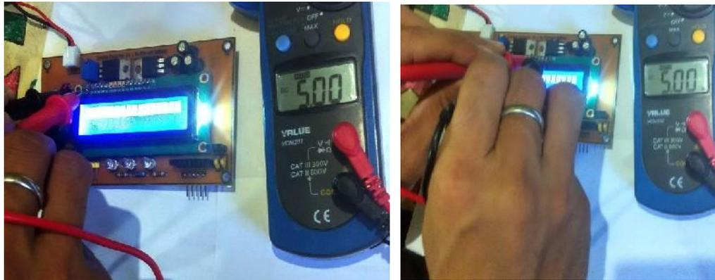
**Gambar 4.3** : Pengujian Tegangan pada pin VCC dan *Backlight* LCD
