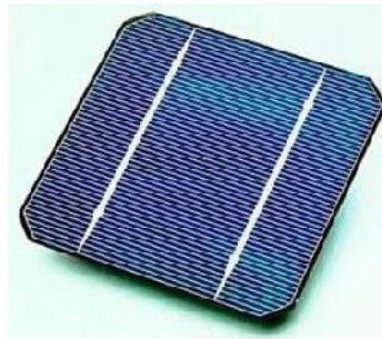
Gambar 2.15 Generasi Pertama Panel Surya berbasis Wafer
