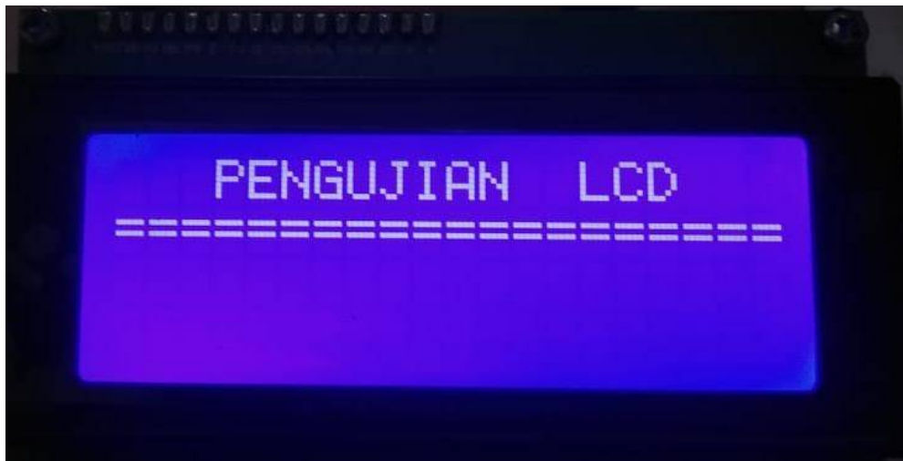
Gambar 4.2 Hasil Pengujian LCD 20 x 4
