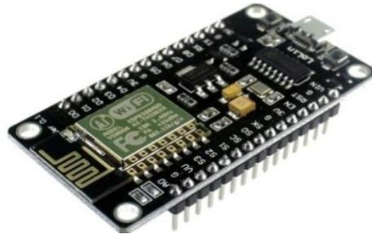
**Gambar 2.4** NodeMCU ESP8266 Wifi.
