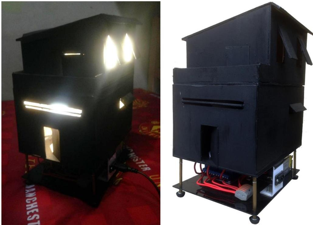
**Gambar 4.2** Alat Kendali Rumah dengan NodeMCU Berbasis Android
