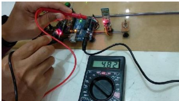
Gambar 4.6 Tegangan Limit Switch Batas Tutup Tidak Ditekan
