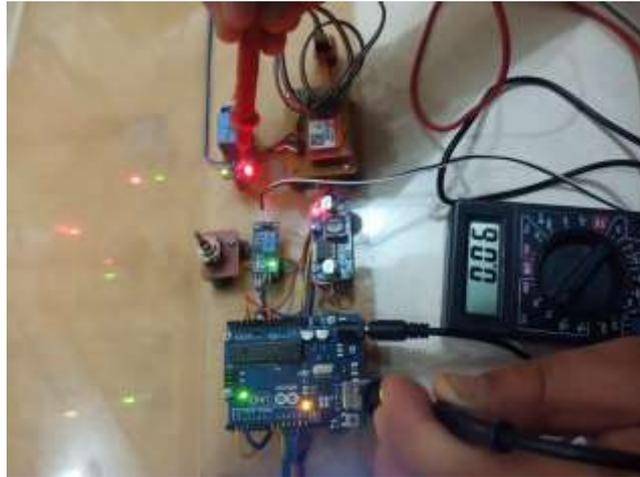
**Gambar 4.8 Tegangan *Output* Arduino ke *Relay* Saat *On***
