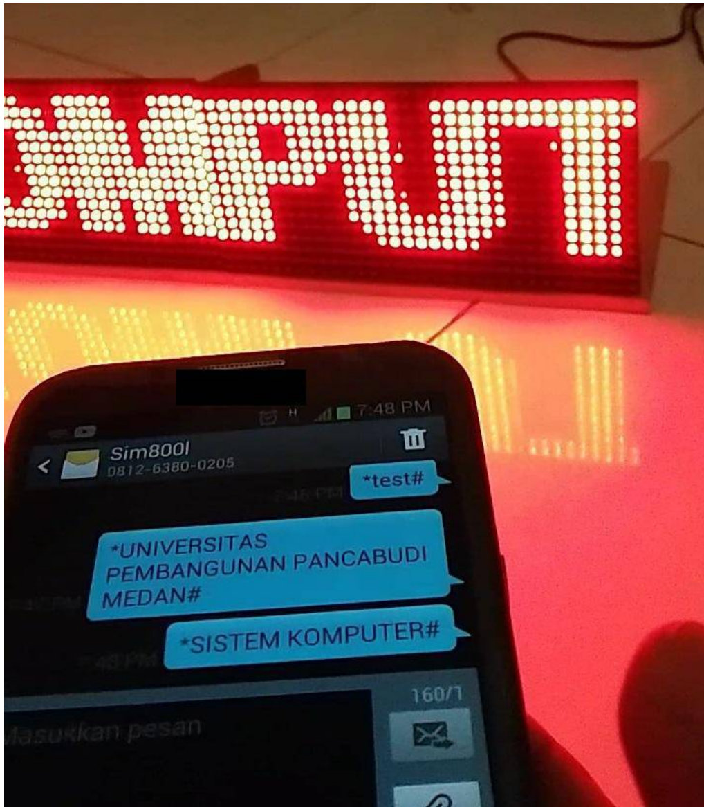
Gambar 4.5 Tampilan Hasil Display P10 Saat Pengujian
