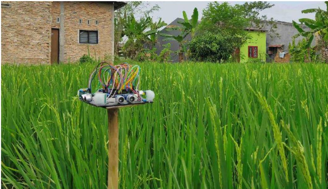
**Gambar 4.1** Pengujian Sensor Ultrasonik
