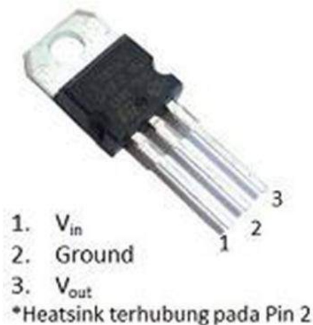
Gambar 2. 12 Susunan kaki IC Regulator 7812
