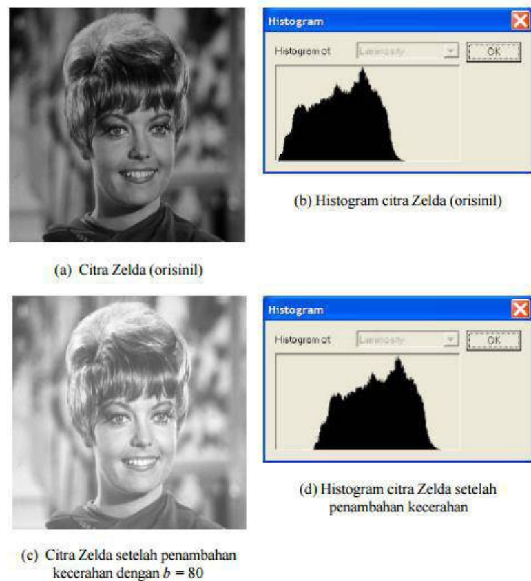
Gambar 2.9 Citra Zelda; (a,b): sebelum operasi penambahan kecerahan terlihat agak gelap; (c,d) citra Zelda setelah operasi penambahan kecerahan dengan b = 80 .
