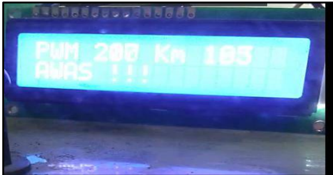
Gambar 4.7 Rangkaian LCD Menampilkan Pesan Awas
