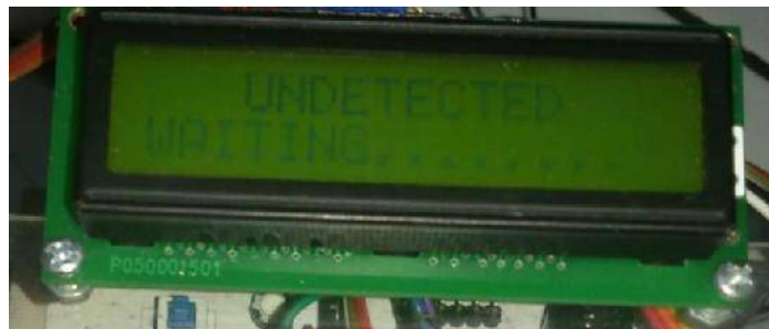
Gambar 4.3 Tampilan undetected dan waiting pada LCD Sumber: Penulis, 2018
