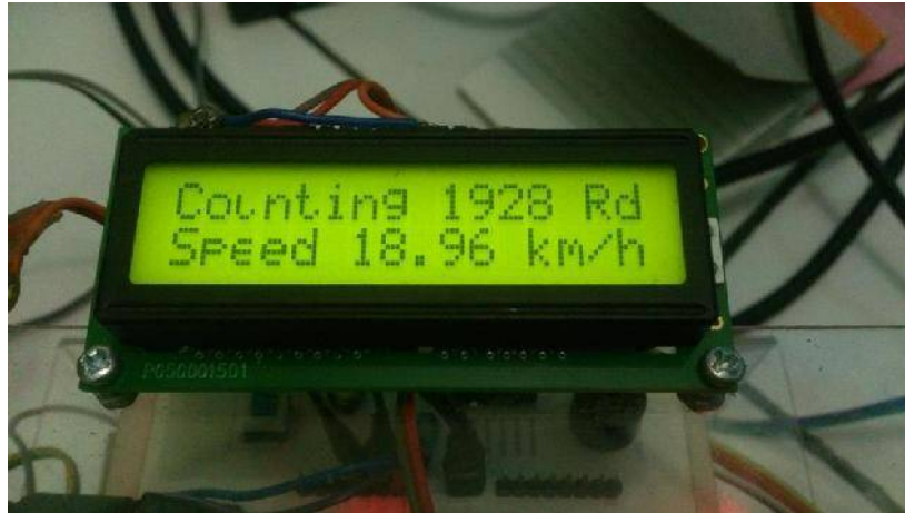
Gambar 4.5 Tampilan nilai kecepatan pada LCD dan Android Sumber: Penulis, 2018
