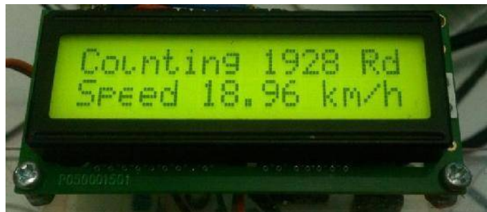
Gambar 4.4 Tampilan nilai counting dan kecepatan pada LCD Sumber: Penulis, 2018
