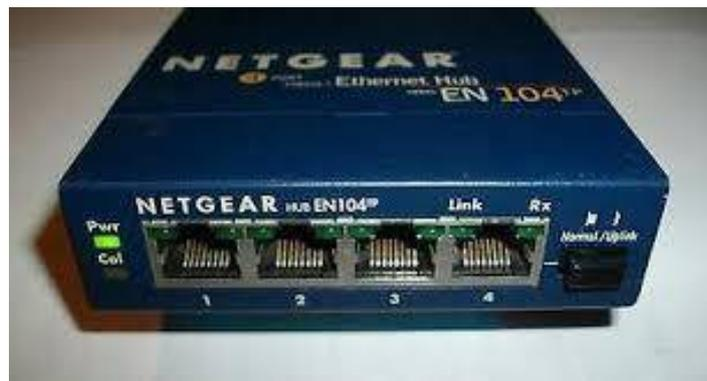
**Gambar 2.17** HUB Dengan 4 Slot RJ45
