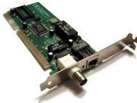
**Gambar 2.9** Kartu Jaringan Menggunakan Antarmuka Slot PCI
