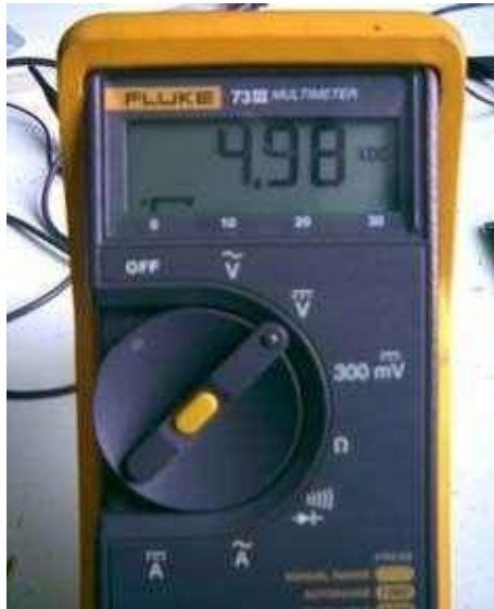
Gambar 4.3 Hasil Pengukuran Pin Mikrokontroler dengan Logika High
