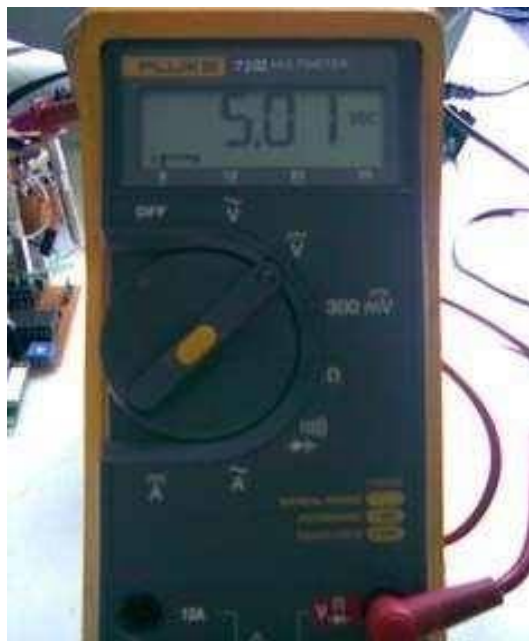
Gambar 4.2 Hasil Pengukuran Keluaran Rangkaian CatuDaya
