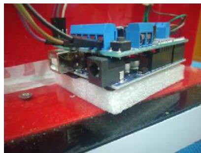
Gambar 4.13 Konfigurasi board Arduino Uno terhadap Driver Motor
