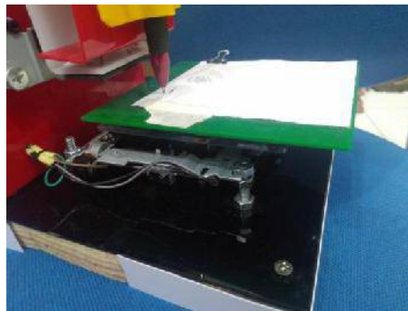
Gambar 4.10 Konfigurasi motor mekanik sumbu “x” yang diletak di triplek
