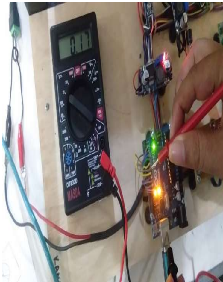
Gambar 4.7 Tegangan photo interrupter kiri tidak terhalang
