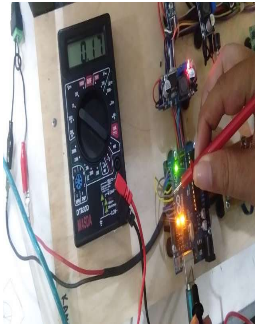
Gambar 4.8 Tegangan photo interrupter kanan tidak terhalang
