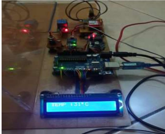
Gambar 4.12 Pengujian Sensor DHT11
