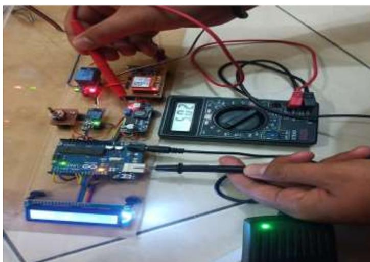
Gambar 4.2 Pengujian Tegangan *Output LM2596*
