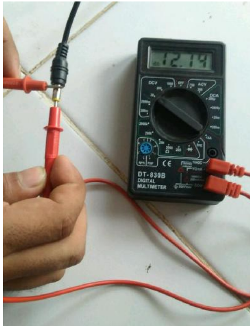
Gambar 4.10 Hasil Pengujian Adaptor 12 Volt Sebelum di Ubah
