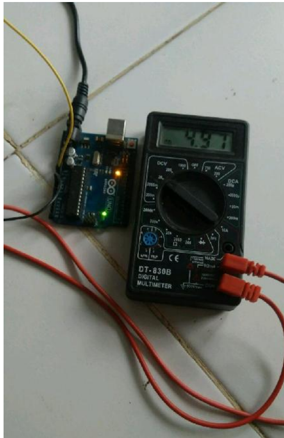
Gambar 4.6 Hasil Pengukuran Mikrokontroler Arduino Uno
