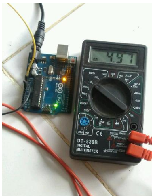
Gambar 4.11 Hasil Pengujian Adaptor setelah di ubah dengan IC Regulator
