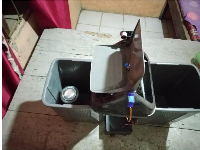
Gambar 4.14 Hasil Pengujian Alat dengan sampah anorganik
