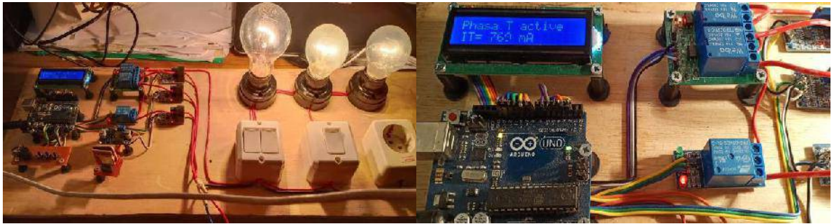
Gambar 4. 14 Phasa T aktif I_r = 760\text{mA}
