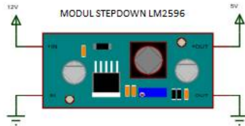
Gambar 3.7 Rangkaian Modul Stepdown LM2596
