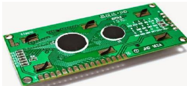
Gambar: 2.27 Liquid Crystal Display 2x16 Tampak Belakang Sumber: Penulis,2020
