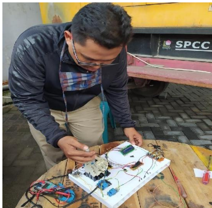
Gambar 4.2 Pengujian Tegangan Kontaktor Sumber: Penulis,2020
