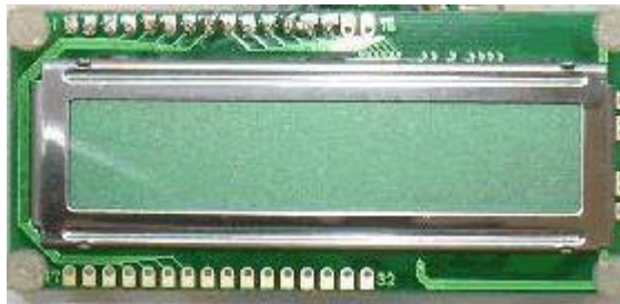
Gambar: 2.26 Liquid Crystal Display 2x16 Tampak Depan Sumber: Penulis,2020
